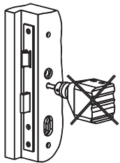
Wanneer het slot is geplaatst niet in de deur boren.
